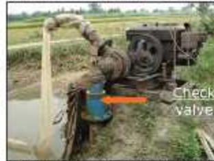
চিত্র ১৪। অগভীর নলকূপে চেক ভাষের ব্যবহার।
