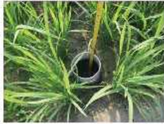
চিত্র ১৭। এডব্লিউডি পদ্ধতিতে পাইপে পানি পর্বক্ষেপণ।
